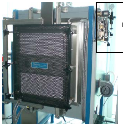
Рис. 2. Печь с узлом регулируемой подачи газа
