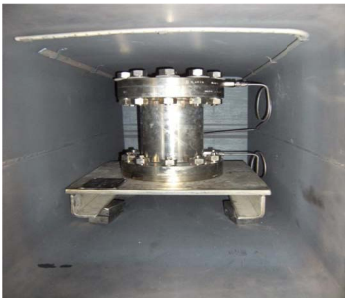
Рис. 1. Общий вид штампа для горячей листовой штамповки в собранном виде
